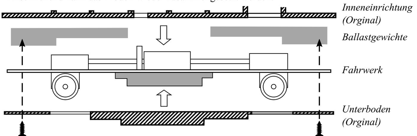
Der Antrieb ist für 2-Leiter Gleichstrom mit einer Nennspannung von 12 Volt geeignet. Nach längerer Betriebszeit empfehlen wir ein Ölen der Lagerstellen aller rotierenden Teile und der Schnecke. Dazu sollte nur säure- und harzfreies Öl verwendet werden. Wir wünschen viel Freude beim Umbau und gute Fahrt!
