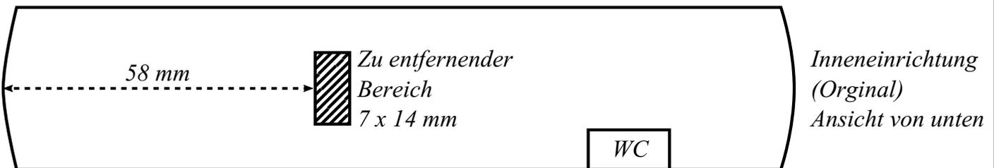
In der Bodenverkleidung müssen die vorhandenen Öffnungen vergrößert werden, um Platz für die neuen Getriebeblöcke zu schaffen. Weiterhin sind zur Montage der beiden separaten Ballastgewichte 4 Schraublöcher mit einem Durchmesser von 2,2 mm zu bohren.
